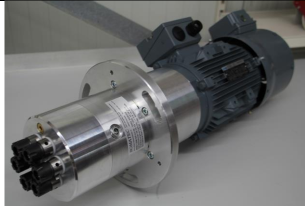
Bearbeitungseinheit MSK13-02 angeflanscht an Motor zum Bohren und Gewindeschneiden
