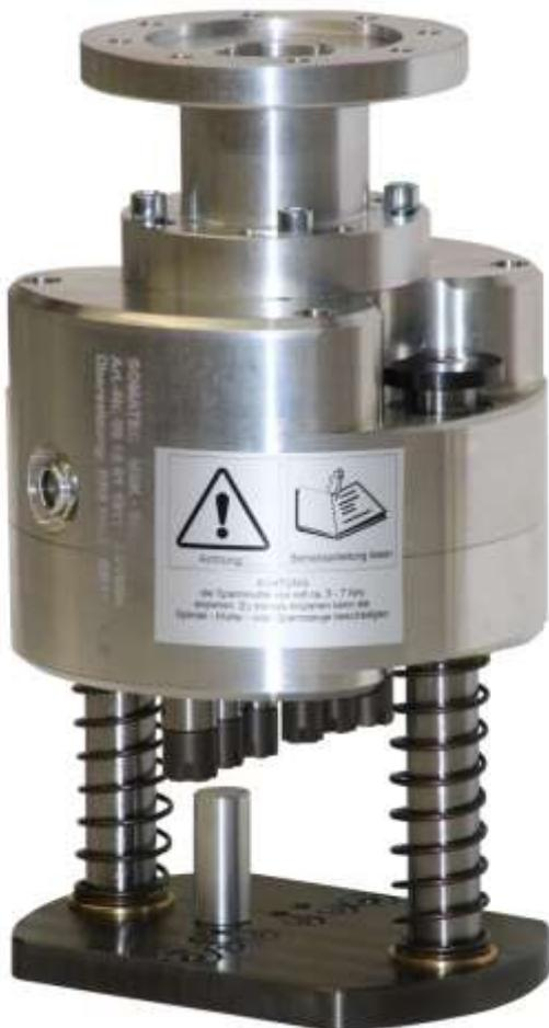
*Die linke Abbildung zeigt das Bohrbild „GU“ in der Sonder-Ausführung mit integrierter gefedertem Bohrerführung und kundenspezifischem Sonder-Antriebsflansch.*
