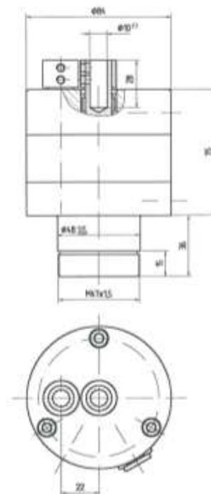
**Ecklagerbohrkopf für den Holzfensterbau Rotobeschlag**
